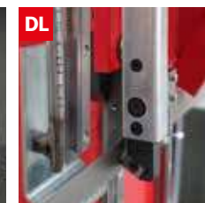
Dispositivo controllo deviazione lama (CNC) Blade deflection control device (CNC)
