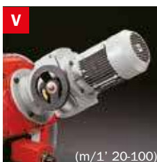
Motovariatore Blade speed variator
