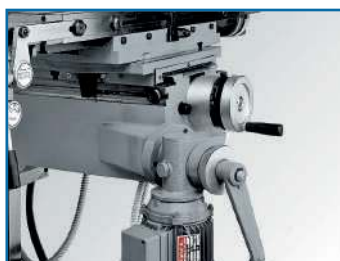
CODE 40006: Avanzamento rapido verticale della tavola Rapid vertical table feed
