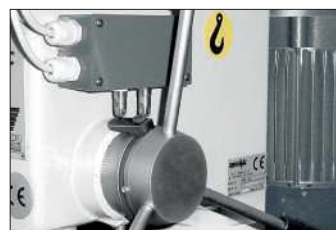
Code 18080: Filettatura con teleinvertitore.
