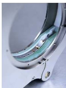
Montaggio più facile degli elettrodi grazie alle indicazioni Ø 1,6/2,4 mm (0.063"/0.094")
